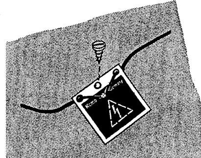
D) Mit einer Blechschraube werden die Hochspannungsplättchen im Motorraum befestigt. Der Schraubenkopf darf nicht die Hochspannungs-Metallfläche auf den Plättchen berühren.
